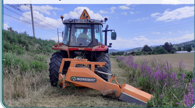
Fauchage des abords des voies communales
